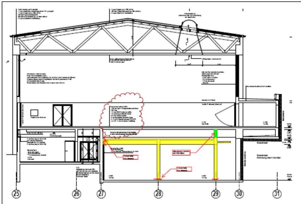
**Bild 1: Querschnitt Sporthalle mit „Polizeigaragen“**
