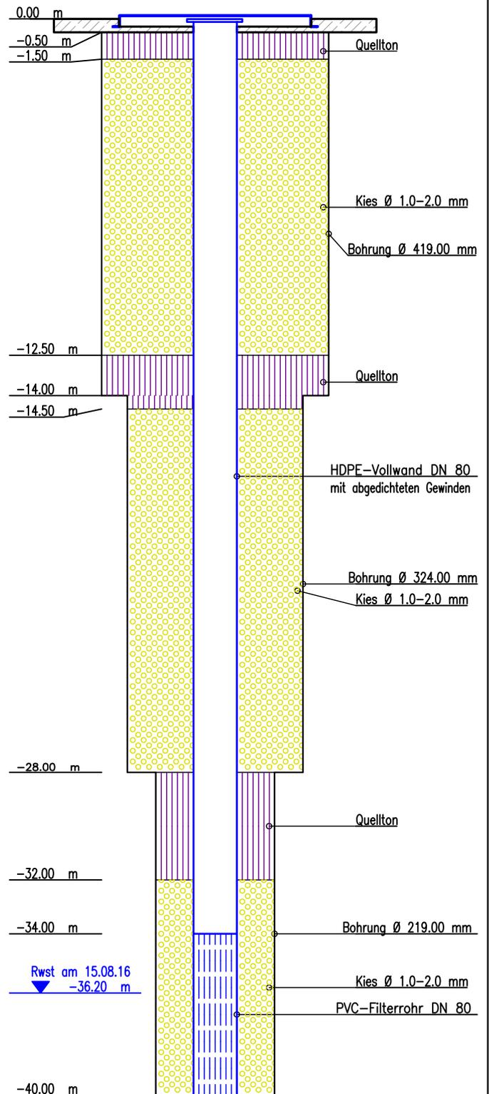
Pumpprobe mit max. Leistung 1,2 m<sup>3</sup>/h möglich
