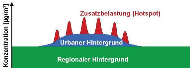
Abbildung 3: Schema der Zusammensetzung der städtischen Gesamtbelastung (Lenschow et.al., 2001)
