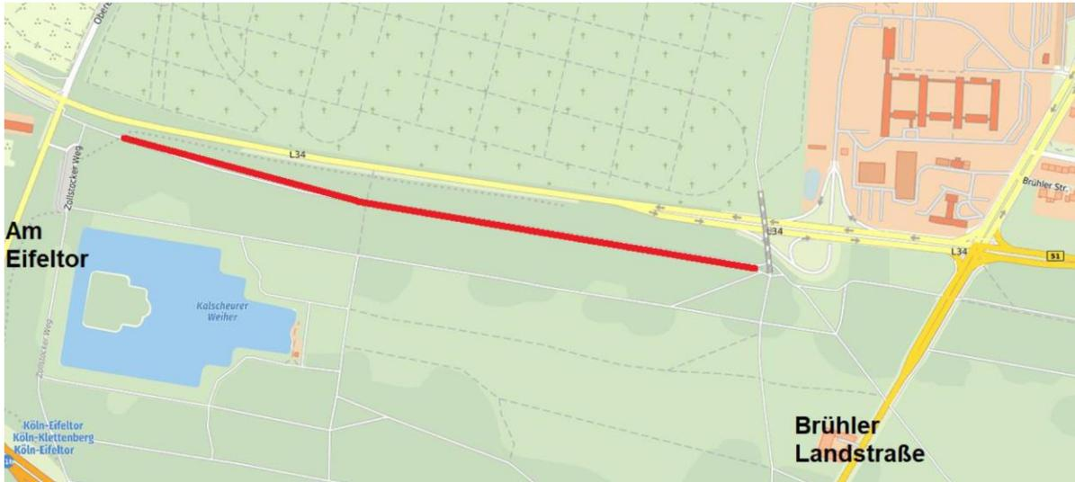
Die bestehende ca. 2,00 m breite asphaltierte Fläche wird zurückgebaut und teilweise entsiegelt. Zur langfristigen Vermeidung von Wurzelschäden wird der ca. 5,00 m breite Geh- und Radweg mittig zwischen den Waldgrenzen errichtet.
