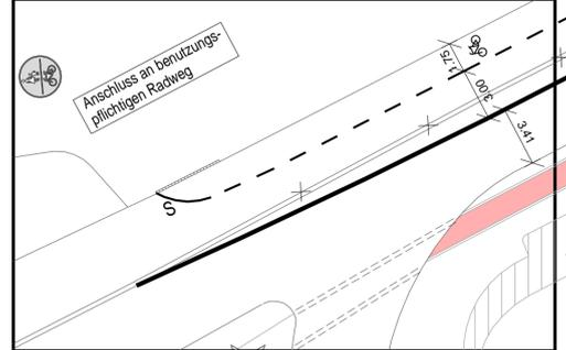
Plattenumlage im Wurzelbereich: nach Entfernen des Radwegs und Freilegen der Wurzeln ist das Amt für Liegenschaften und Grünflächen zu informieren; Herstellung neue Oberfläche nach örtlichen Gegebenheiten in Kleinpflaster oder als wassergebundene Decke (siehe auch Kurzbeschreibung LV)
