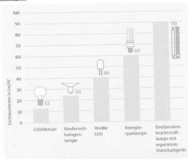
Die Einheit Lumen / Watt (lm/W) gibt an, in wie viel Licht ein Watt elektrische Energie umgewandelt wird. Hier gilt: je mehr Licht pro Watt, desto effizienter die Lampentechnologie.
